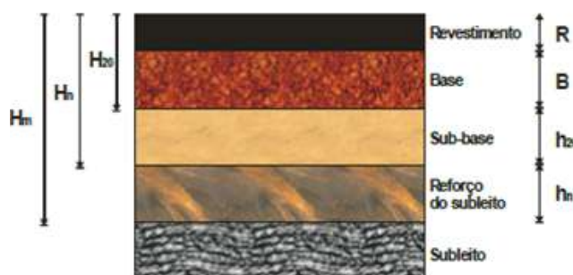
Figura 9 - Estrutura do pavimento
